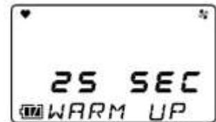
После двойного звукового сигнала газосигнализатор перейдет в режим измерения.
