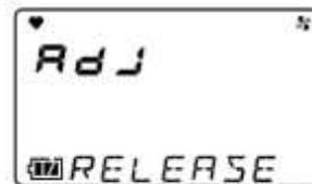
3. При калибровке RX-8500 подключите фильтр CO<sub>2</sub> и нажмите кнопку ENTER.
